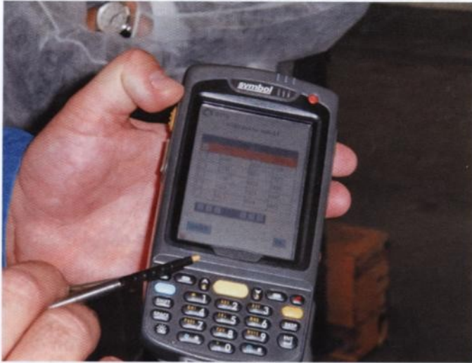
Bild 2 Um den PDA leicht bedienen zu können, wurde die Benutzeroberfläche für die SAP-Materialbuchungen mit Hilfe der Java-Technologie intuitiv gestaltet. Bilder: Gerresheimer/Klumpff
